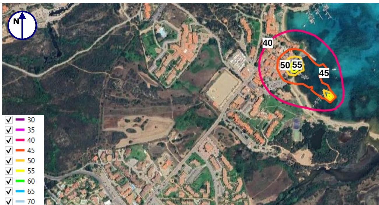
Figura 25: Risultati dell'elaborazione del modello di calcolo relativo all'esercizio in periodo diurno (06-22) con isofofoniche
